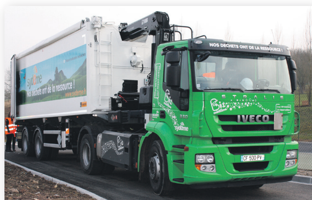
Semi-remorque de collecte du papier / verre et son tracteur fonctionnant au GNV
