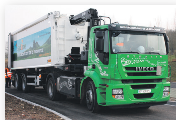
Semi-remorque de collecte du papier / verre et son tracteur fonctionnant au GNV
